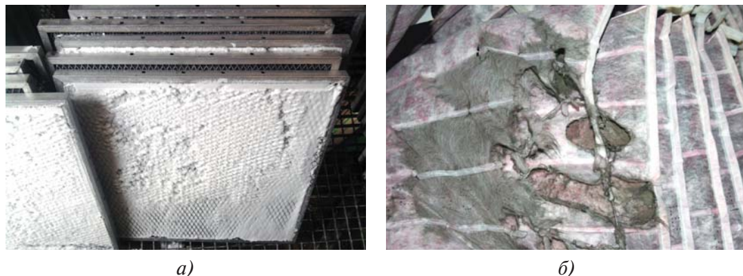
Рис. 1.22. Фильтры компании Camfil Farr: а) блокирование снегом металлического коагулятора; б) разрыв фильтровального материала карманного фильтра
