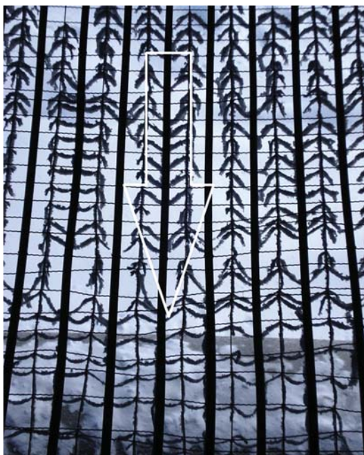
Рис.2.50. Изменение плотности инея по высоте сетки от птиц и мусора [15]
