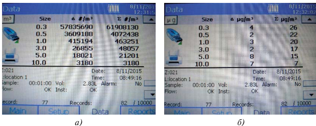
Рис. 4.20. Количество (а) и концентрация (б) частиц на всасе КВОУ ГТУ ТЭЦ в МО
