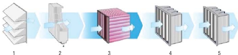
Рис. 3.13. Трехступенчатая система фильтрации циклового воздуха ГТУ: 1 – погодные козырьки; 2 – жалюзийный каплеуловитель; 3 – карманный ФГО; 4 и 5 – кассетный ФТО
