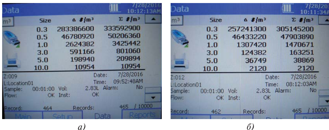
Рис. 4.13. Количество взвешенных частиц в кубометре атмосферного воздуха на всасе КВОУ ТЭЦ-1 в ЮАО (а), ТЭЦ в ЗАО (б)
