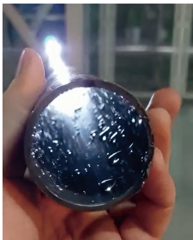
Фото 5.17. Состояние труб орошения после очистки
