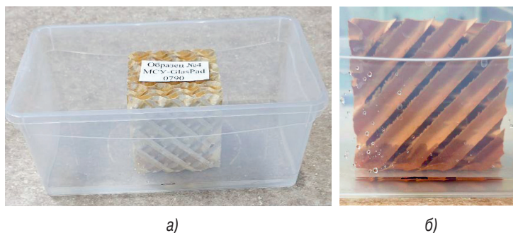
Фото 8.34. Образцы кассет в процессе тестирования на капиллярную впитываемость: а) № 4; б) № 3
