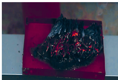
Фото 8.40. Образец № 2 CeLPad 0790: а) перед испытанием; б) во время; в) после испытания на горючесть
