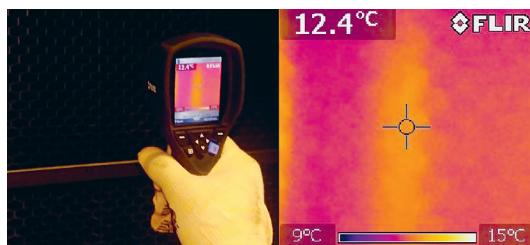
Фото 3.14. Термограммы ОУ ИТ ТЭЦ-3 во время работы: а) перед ОУ ИТ; б) за каплеуловителем
