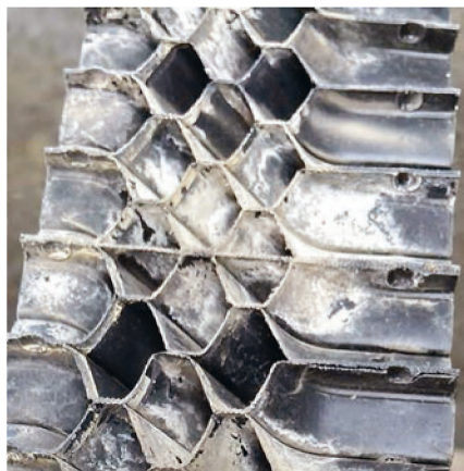
Фото 7.5. Глубина проникновения загрязнений внутрь: а) кассет; б) каплеуловителей
