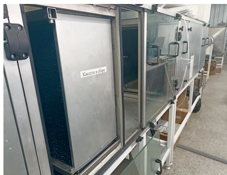
Фото 7.18. Тестирование образцов 1 и 2 на аэродинамическом стенде
