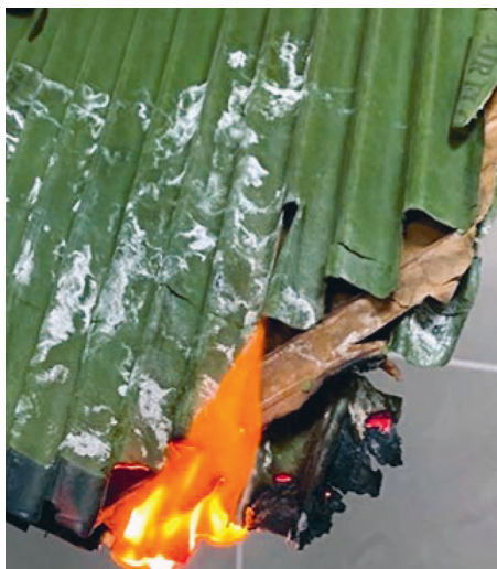
Фото 7.4. Горение материала кассет из целлюлозы
