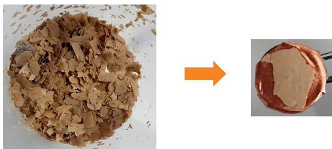
Фото 4.11. Подготовка образца отложений для сканирования на ЭСМ
