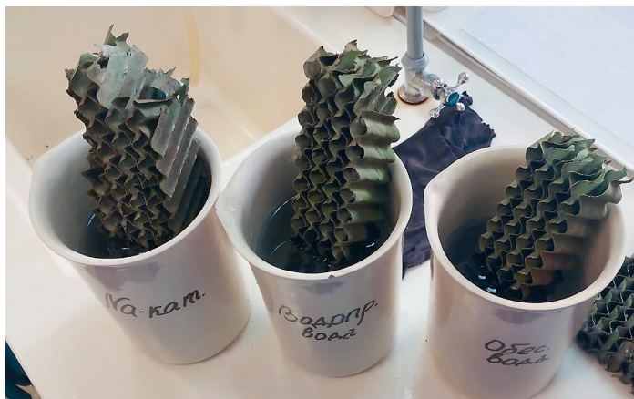
Фото 5.9. Образцы материала испарительных кассет, помещенные в различные виды воды
