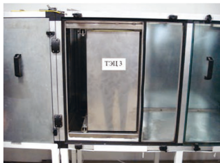
Фото 7.7. Тестирование образца кассеты TURBOdek с ТЭЦ-3
