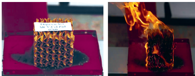
Фото 8.40. Образец № 2 CeLPad 0790: а) перед испытанием; б) во время; в) после испытания на горючесть
