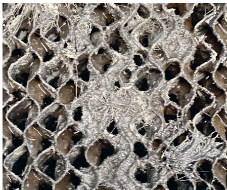
Фото 7.2. Занос кассет ОУ ИТ ГТУ тополиным пухом и двукрылыми насекомыми
