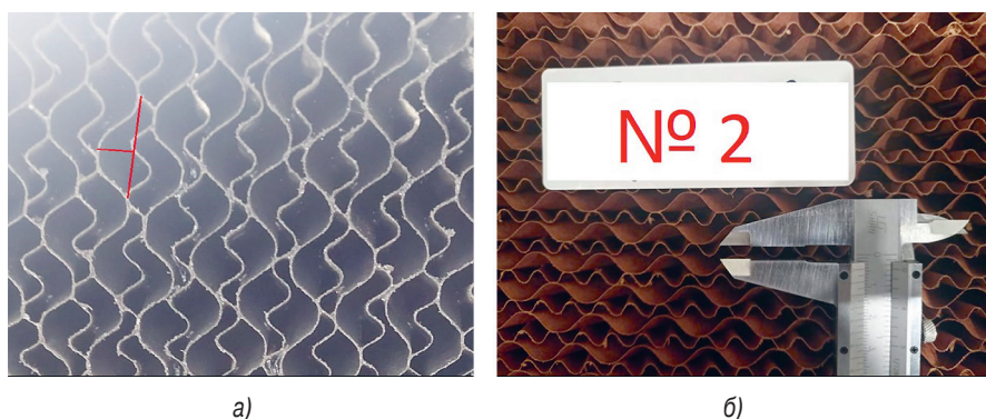
Фото 7.17. Размеры гофр МСУ новых кассет: а) измеряемые размеры; б) инструментальный замер
