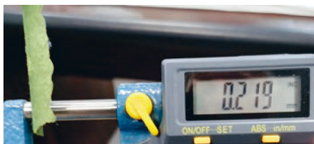
Фото 7.3. Толщина материала кассет ОУ ИТ компании Munters
