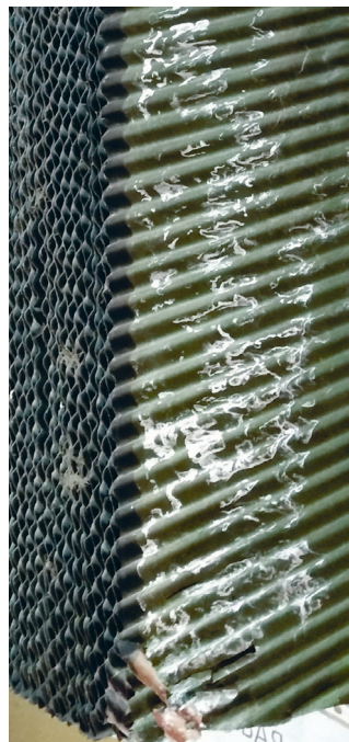
Фото 4.9. Отложения на испарительных кассетах ОУ ИТ в ЮФО
