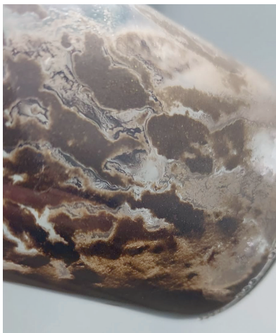
Фото 5.15. Отложения при использовании умягченной воды
