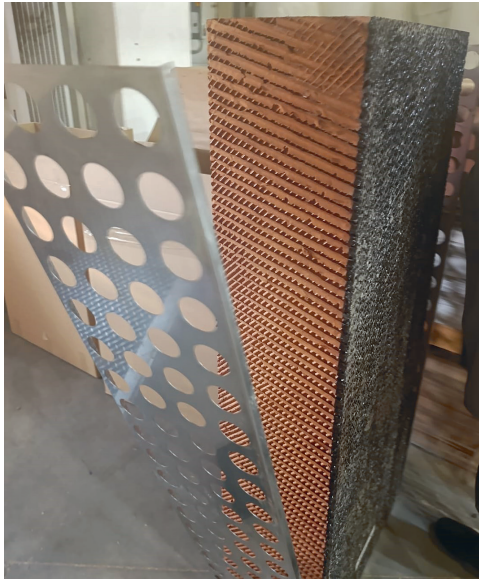
Фото 8.61. Проверка состояния материала кассет после окончания эксплуатации в ОУ ИТ ГТУ
