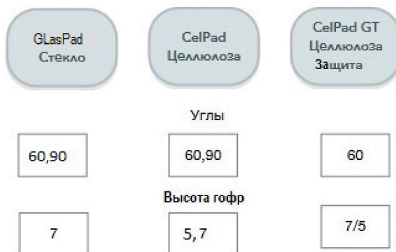
Рис. 8.18. Характеристики МСУ: углы установки слоев относительно потока воздуха, высота гофр
