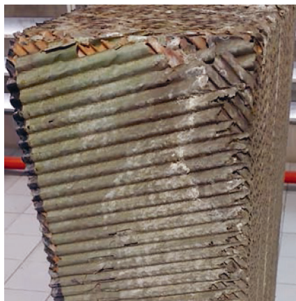
Фото 7.5. Глубина проникновения загрязнений внутрь: а) кассет; б) каплеуловителей
