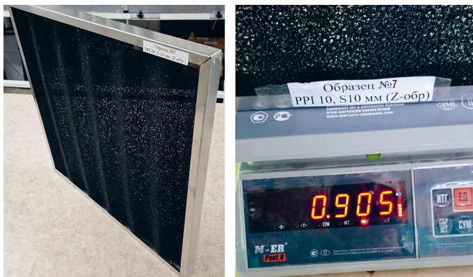
Фото 8.47. Образец № 7 PPI: а) внешний вид; б) взвешивание
