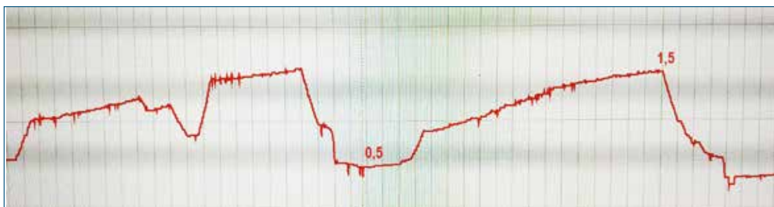
Рис. 7. Тренд роста перепада давления на штатных противомоскитных сетках 18.06.2018
