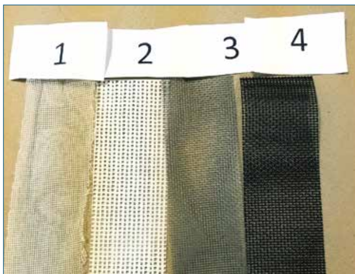
Рис. 11. Образцы сеток для тестирования на разрыв
