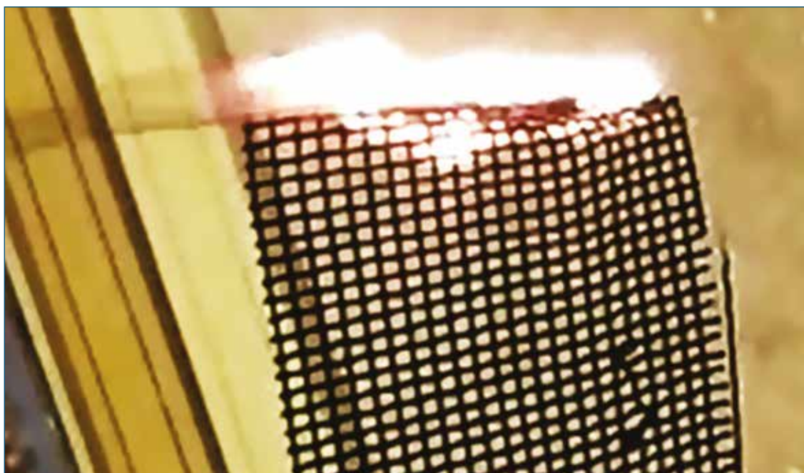
Рис. 13. Тестирование образца №4 на горючесть
