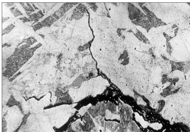
Рис. 5. Межкристаллитные трещины в литом тройнике ( \times 100 )
