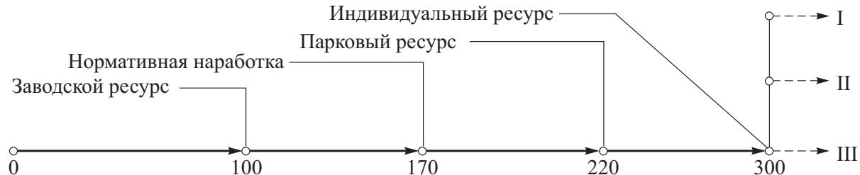
**Ретроспективная динамика последовательного уточнения ресурса металла элементов и узлов турбинного оборудования 13 – 24 МПа, 540 – 560°C (цилиндры, роторы ВД и СД, стопорные, регулирующие клапаны и др.):**
