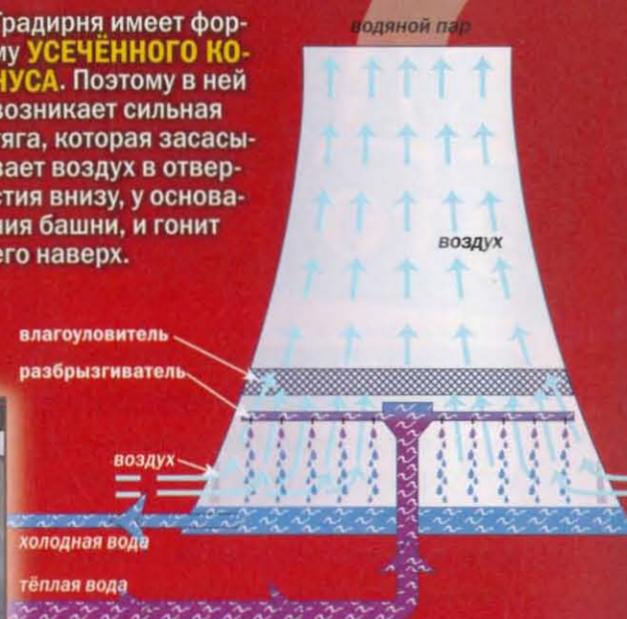
На поднимающиеся потоки холодного воздуха капает горячая **ЦИРКУЛЯЦИОННАЯ ВОДА** из разбрызгивателя. Она остывает на лету и попадает в бассейн на дне градирни, а оттуда возвращается в производственный цикл.
