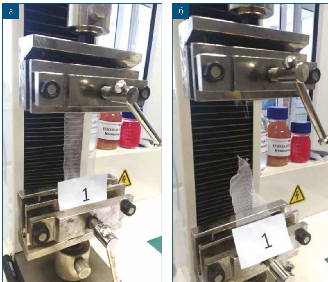
Рис. 12. Тестирование образца №1 на разрыв: а – до начала теста; б – после окончания теста
