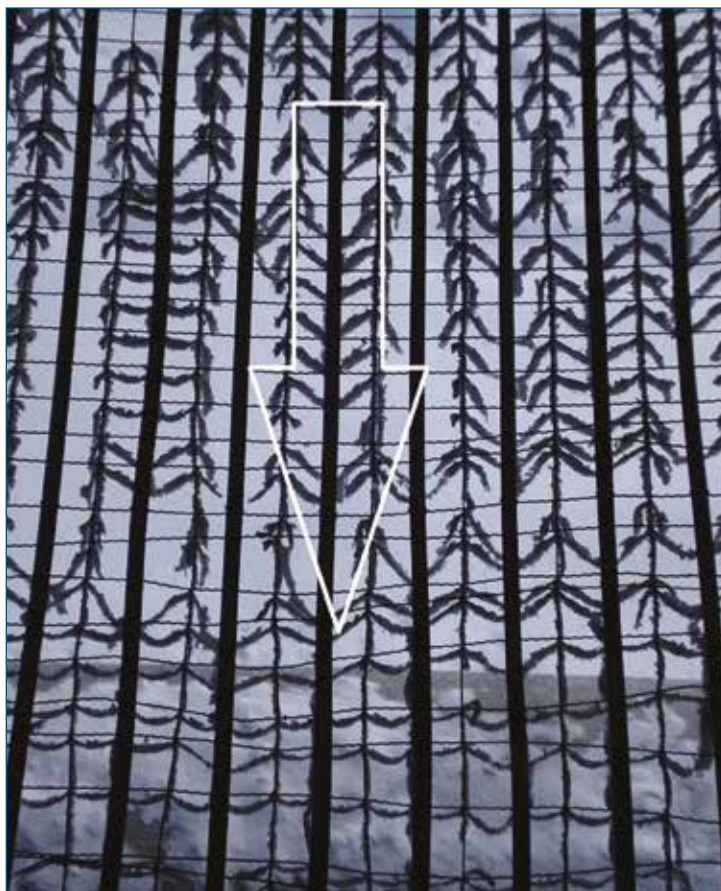
Рис. 10. Изменение плотности инея по высоте сетки от птиц и мусора
