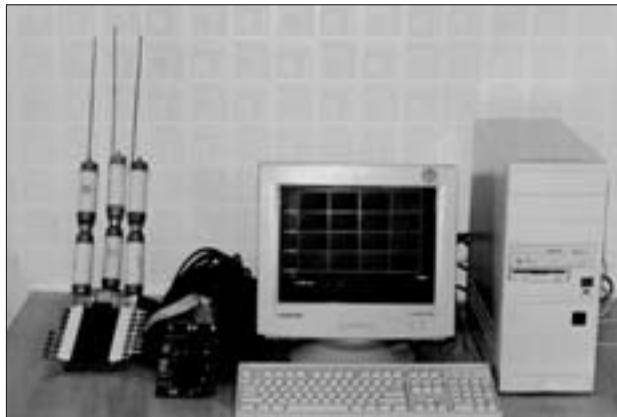
Рис. 1. Аппаратно-программный комплекс для мониторинга переходных процессов в распределительных сетях
