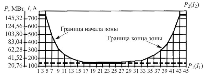
Рис. 4. Зона опасного влияния на ремонтируемой линии в зависимости от нагрузки (тока) на влияющей линии:
