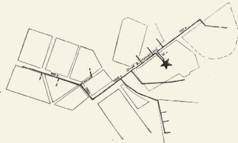
Схема тепловых сетей по району Сталинской ТЭЦ на 1935 г.
