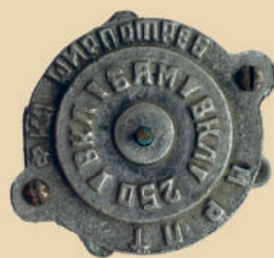
Выключатель с ГЭС-1
