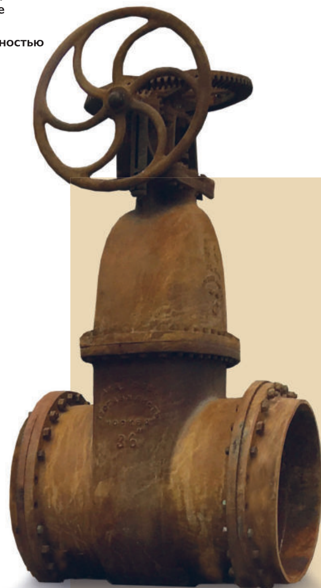
Водопроводная задвижка 36 дюймов (865 мм). Более ста лет проработала на ГЭС-2
